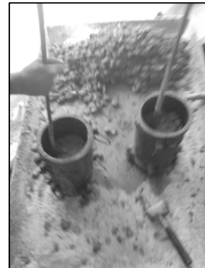
Pemadatan beton segar didalam cetakan
