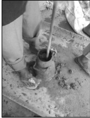
Memasukkan Beton Kedalam Kerucut Abrams
