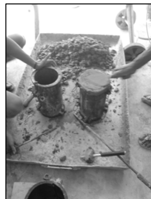
Memasukkan Beton Segar Kedalam Cetakan
