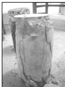
Hasil Sampel Beton Yang telah Dilakukan Pengujian Desak
