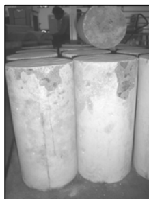
Hasil Sampel Beton Yang telah Dilakukan Pengujian Desak
