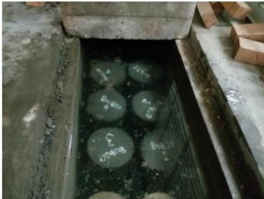
Gambar L-13.8 Perendaman Benda Uji
