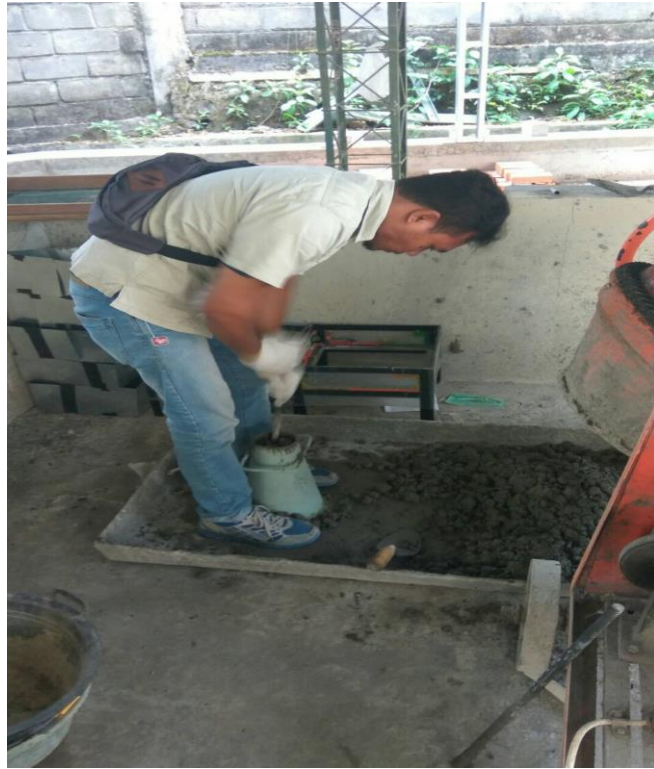
Gambar L-13.3 Pematatan Campuran Beton Pada Kerucut Abrams
