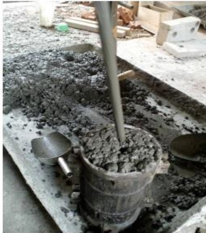
Gambar L-13.5 Pematatan Adonan Beton pada Cetakan Silinder
