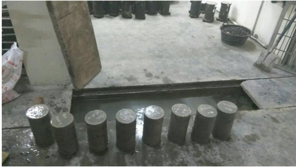
Gambar L-13.9 Benda Uji Setelah Perendaman
