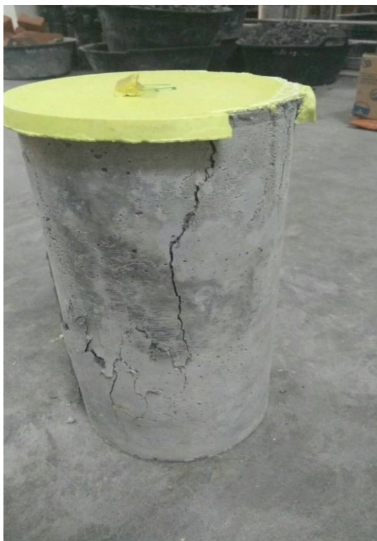
Gambar L-13.12 Pola Keretakan Benda Uji
