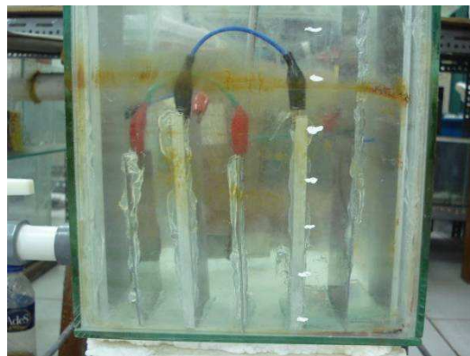
Gambar 3.2 Bak Elektrokoagulasi dengan Jarak Plat 3 cm
