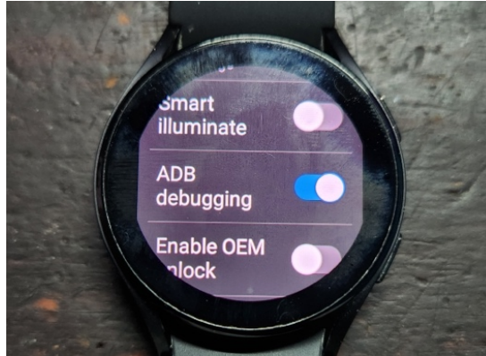
Gambar 4.1. Mengaktifkan ADB dan Wireless Debugging
