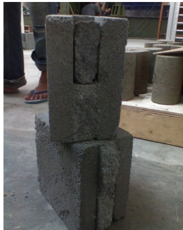
Gambar 5.3 Pola Kerusakan pada Uji Geser
