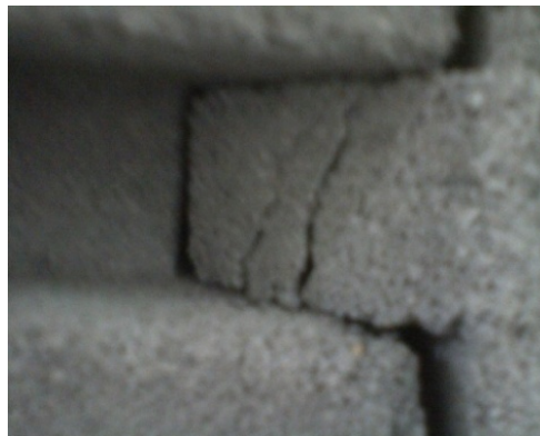
Gambar 5.2 Pola Kerusakan pada Uji Lentur
