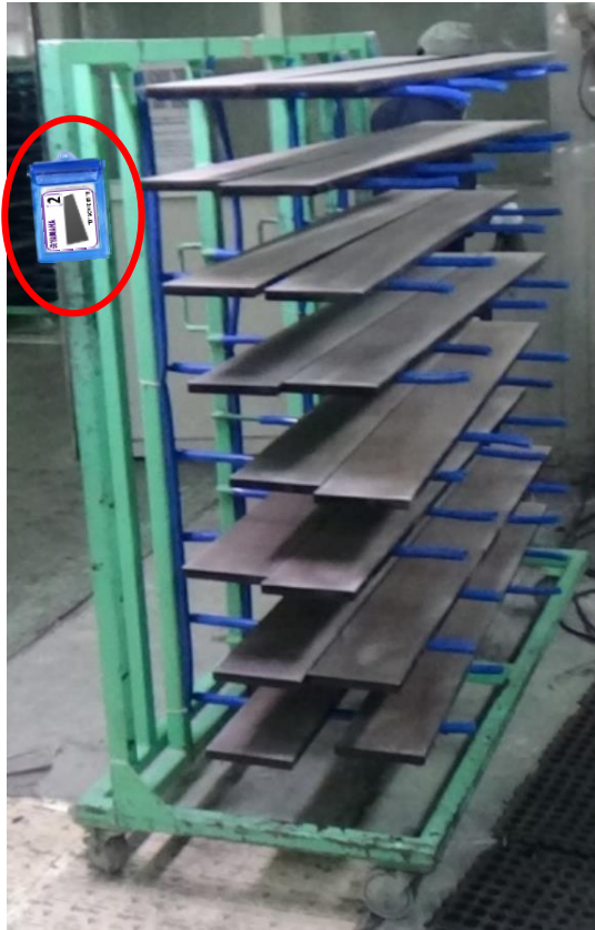
Gambar 5. 2 Ilustrasi Penempatan Kartu RFID pada Rak
