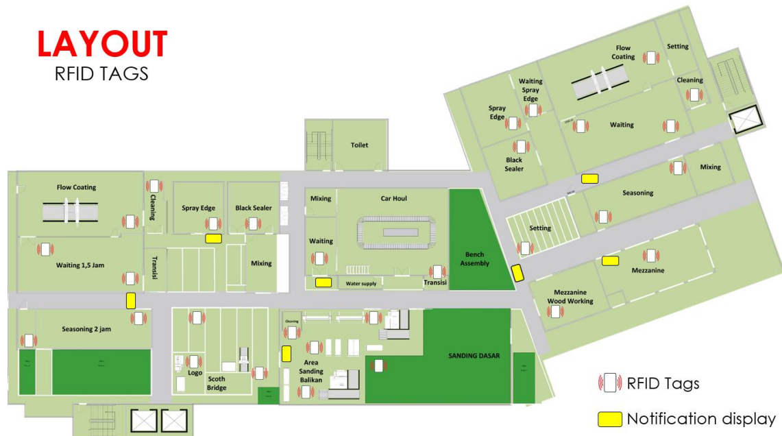
Gambar 5. 3 Visualisasi Penempatan Sensor RFID dan Notification Display
