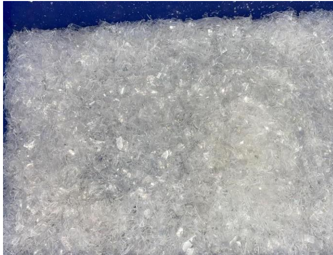
Gambar 3. 25 Thinwall yang sudah dicacah
