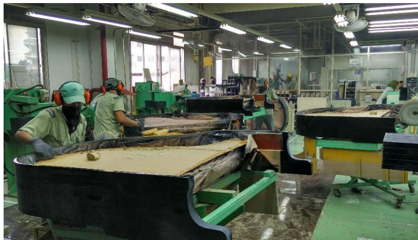
Gambar 4. 6 Alur Proses Polisher Edge dan Permukaan
