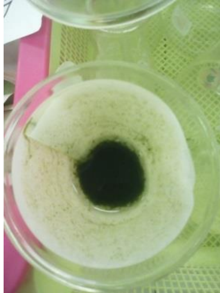
Gambar 4.9 Proses penyaringan mikroalga dengan kertas filter Whatman
