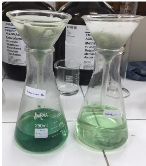
Gambar 4.11 Proses pemisahan filtrat setelah dilakukan ekstraksi pada sampel W42 (kiri) dan sampel W1 (kanan)
