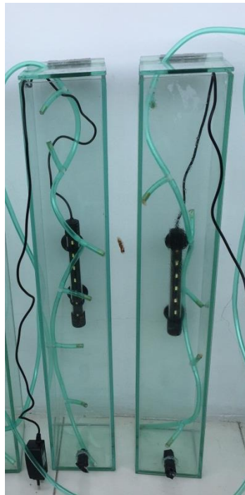
Gambar 4.2 Reaktor yang Digunakan pada Proses Kultivasi
