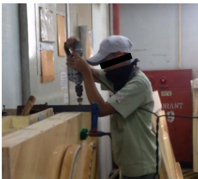
Gambar 4. 8 Proses penggunaan mesin Bor Frame & Custer
