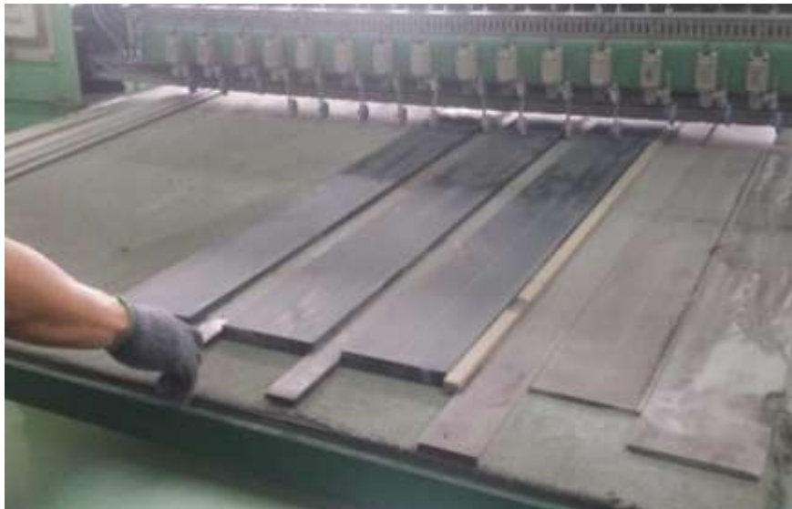
Gambar 7. Proses sanding permukaan mesin sanding #500 sesudah kaizen
