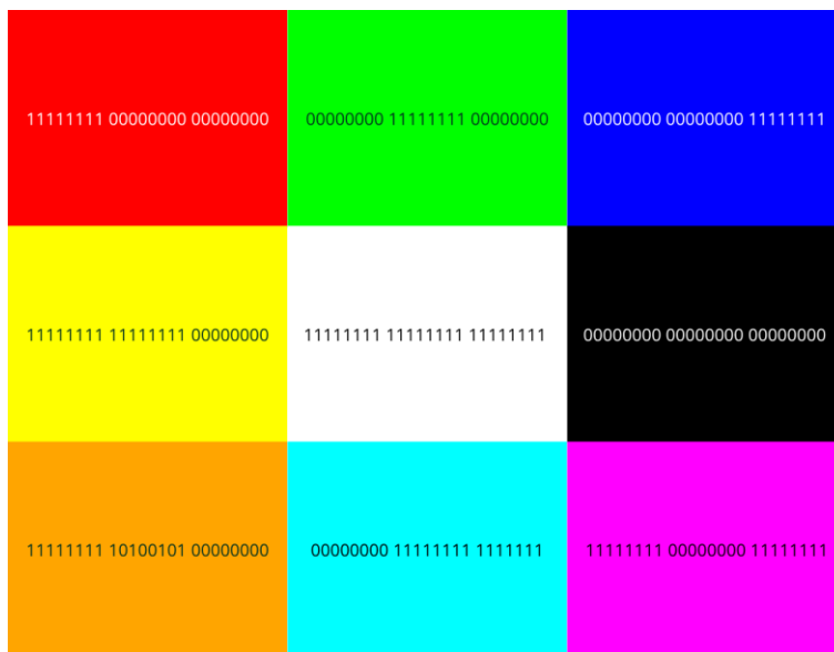
Gambar 2.1 Ilustrasi Kombinasi Kanal RGB dalam Citra 24-bit.
