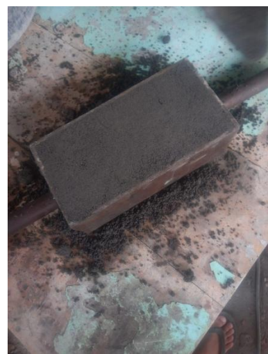
Pencetakan Paving Utuh
