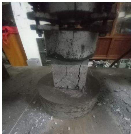
Gambar 4.30 Pengujian Kuat Tekan Paving
