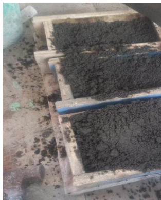
Gambar 4.27 Penggabungan Paving dan Lapisan Plastik
