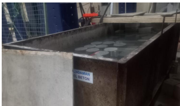
Gambar 4.31 Pengujian Serapan Air Sampel Paving
