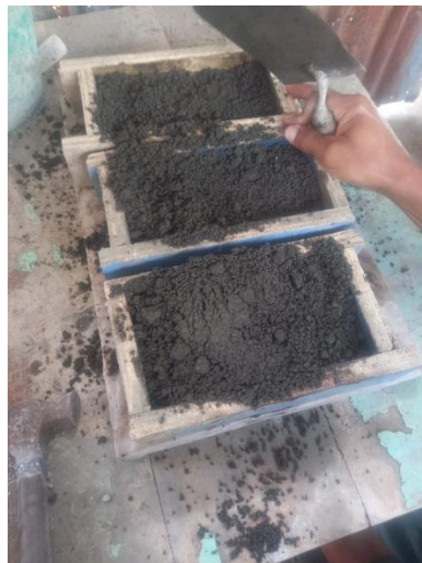
Pencetakan Paving Belapis Plastik
