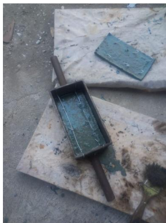
Gambar 4.24 Pencetakan Lapisan Plastik
