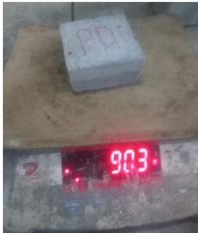
Penimbangan Kembali Sampel PD1 Setelah Dikeringkan Menggunakan Oven
