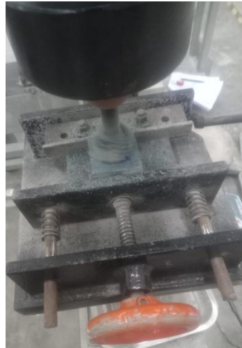
Gambar 4.32 Pengujian Keausan Sampel Paving
