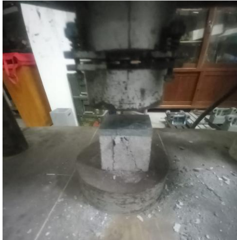
Pengujian Kuat Tekan Sampel TC2
