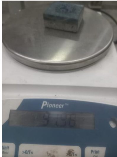
Penimbangan Kembali Kehilangan Aus Sampel B2
