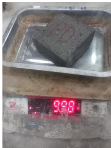
Penimbangan Penyerapan Air Sampel PD1
