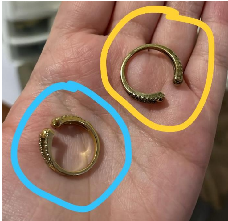
Gambar 2. 7 Perbandingan Plating Gagal (Kuning) dengan Plating Berhasil (Biru)
