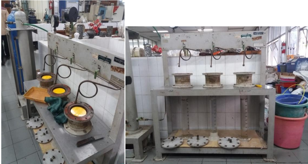
Alat Pengujian Permeabilitas
