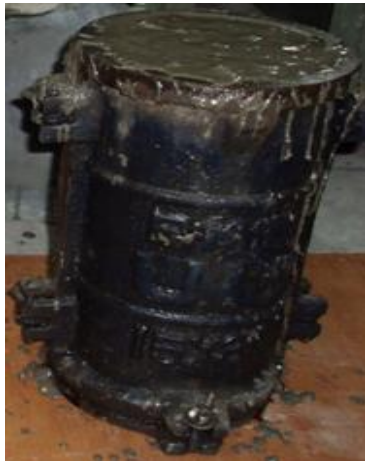
Gambar 4.9 Cetakan Silinder Beton
