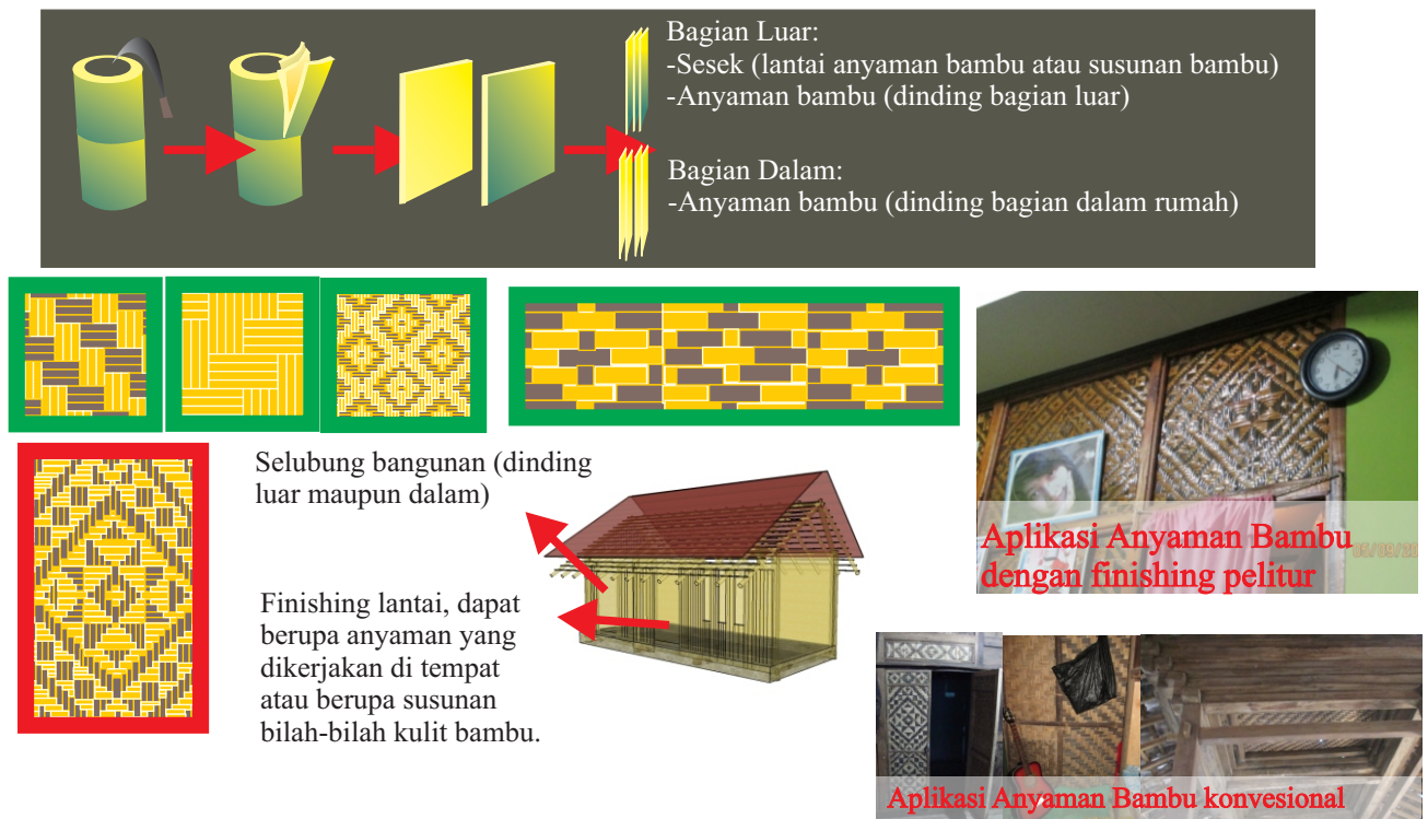
Gambar 3.22. Metode pembuatan anyaman bambu khas Purwodadi. Sumber: Analisis
