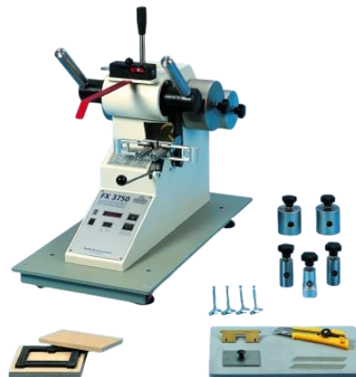
Gambar 3.3. Alat penguji kekuatan sobek kain (Elmendorf)
