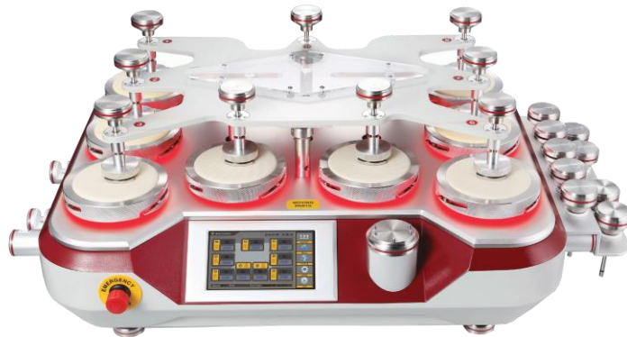
Gambar 3.4. Alat pengujian pilling Martindale
