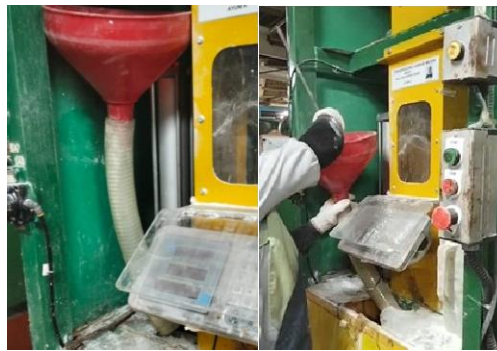
Gambar 4. 30 Input Mesin Mixing Lem Kondisi Before Sumber: Dokumentasi Pribadi
