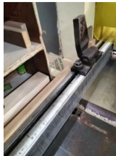
Gambar 4. 24 Meteran Sulit Dibaca Sumber: Dokumentasi Pribadi
