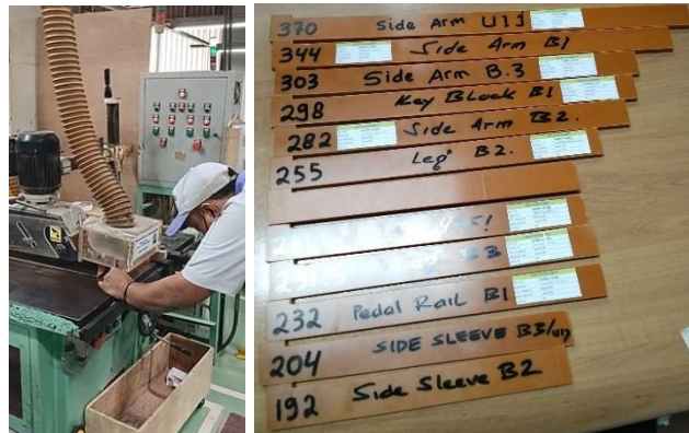
Gambar 4. 48 Setting Mesin Dengan Bantuan Gauge Setting Sumber: Dokumentasi Pribadi
