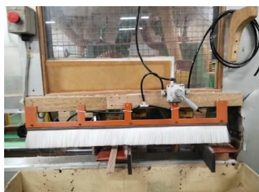
Gambar 4. 51 Penambahan Strip Brush dan Air Blow Sumber: Dokumentasi Pribadi
