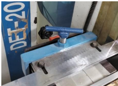
Gambar 4. 41 Clamp Mesin Double Tenoner Kondisi Before Sumber: Dokumentasi Pribadi
