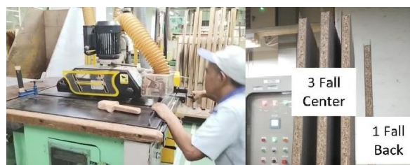
Gambar 4. 47 Proses Setting Mesin Benchsaw dan Hasil Pemotongan Fall Center dan Fall Back Kondisi After
