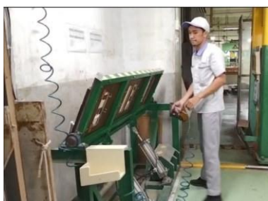
Gambar 4. 53 Operator Membalikkan Tulang Keybed Menggunakan Meja Hidrolik Sumber: Dokumentasi Pribadi
