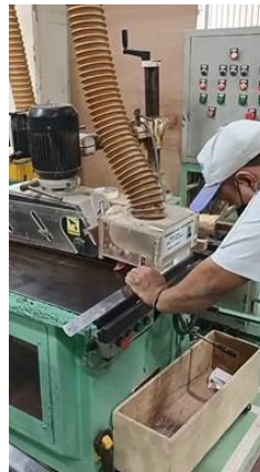
Gambar 4. 29 Setting Mesin Dengan Bantuan Penggaris Sumber: Dokumentasi Pribadi
