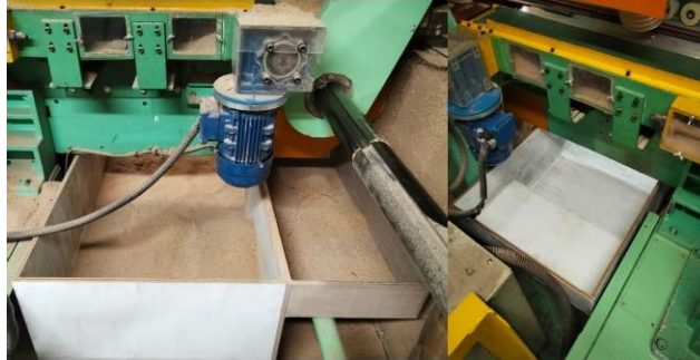
Gambar 4. 50 Desain Bak Penampung Debu Kondisi After Sumber: Dokumentasi Pribadi
