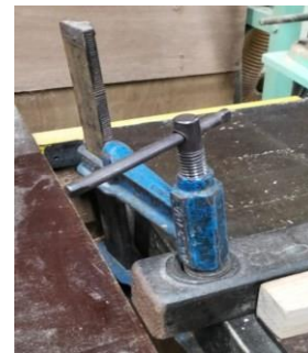
Gambar 4. 23 Clamp Mesin Benchsaw Kondisi After Sumber: Dokumentasi Pribadi
