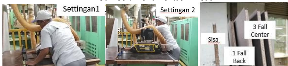
Gambar 4. 28 Proses Setting Mesin Benchsaw dan Hasil Pemotongan Fall Center dan Fall Back Kondisi After Sumber: Dokumentasi Pribadi
