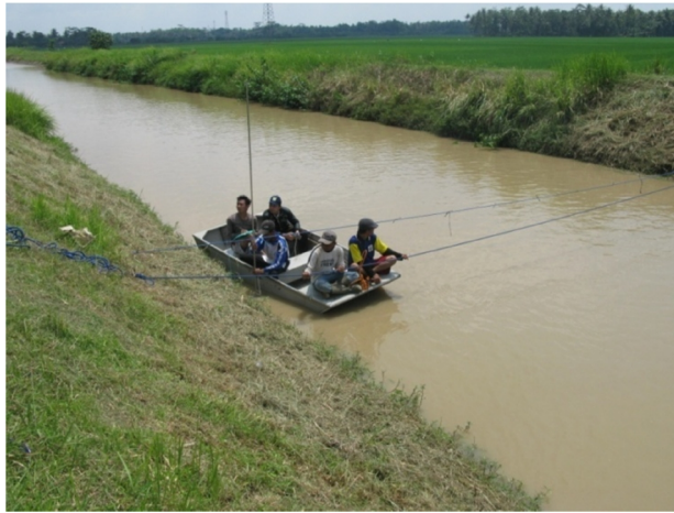
Gambar 5.15 Pengukuran hidrometri pada hulu BS 1
