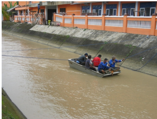
Gambar 5.12 Pengukuran hidrometri di hulu BC 1
