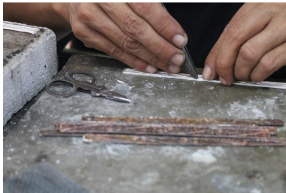
Proses peletakan filling pada frame
