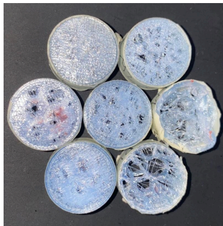
Gambar 4.15 Hasil Yang Gagal Dalam Proses Pengujian
