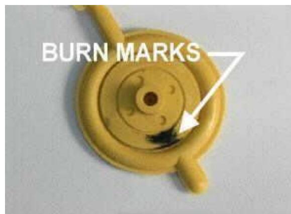
Gambar 4.10 Contoh gambar ilustrasi jenis cacat Gosong
