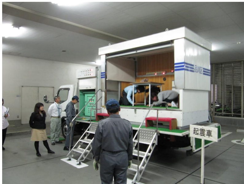
Gambar 2.15. Model Simulator Gempa Yang di modifikasi Pada Mobil
