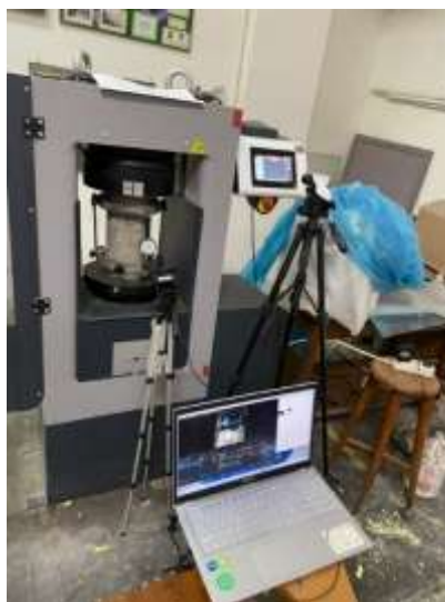
Gambar 5. 16 Proses Pengujian Kuat Tekan Beton
