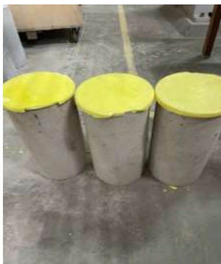
Gambar 5. 17 Hasil Pengujian Kuat Tekan Beton
