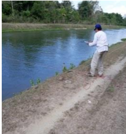
Gambar 2.2 Pengukuran di Saluran Induk dengan Pelampung
