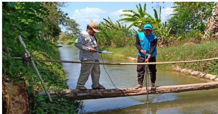
Gambar 2.1 Pengukuran Kecepatan dengan Current Meter
