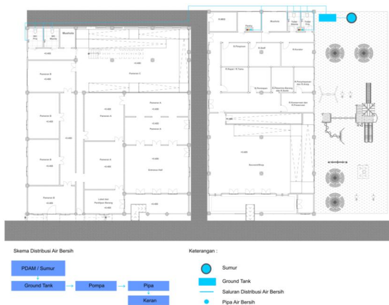
Gambar 6. 8 Skematik Distribusi Air Bersih
