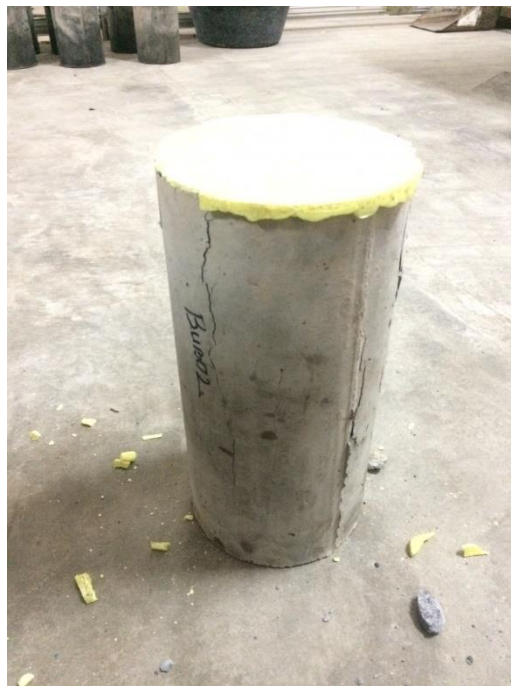
Gambar L-13.10 Pola Keretakan Benda Uji
