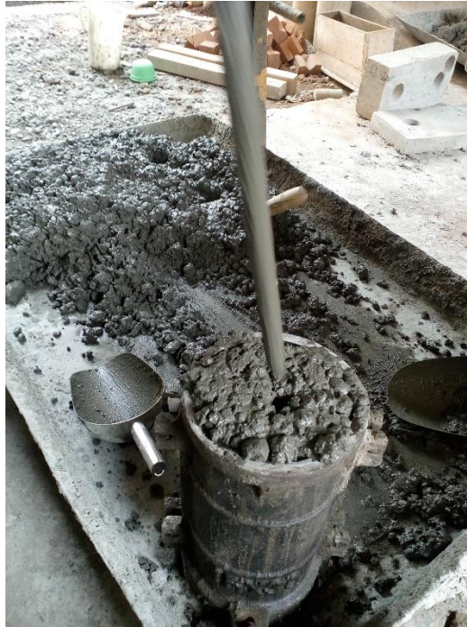
Gambar L-13.3 Pemasangan Adonan Beton pada Cetakan Silinder
