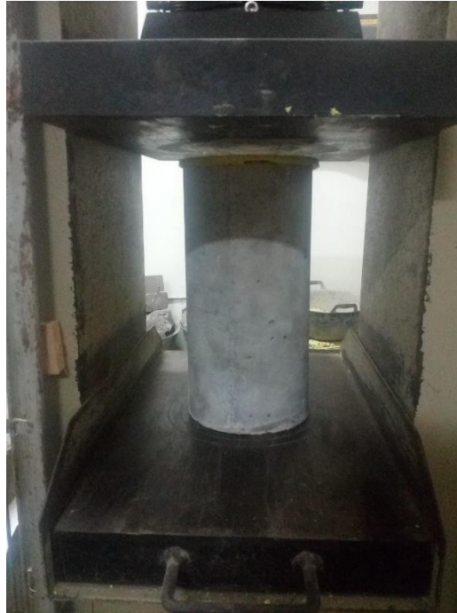
Gambar L-13.9 Pengujian Kuat Tekan Beton
