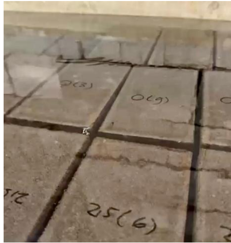
Gambar 4. 17 Perawatan Benda Uji
