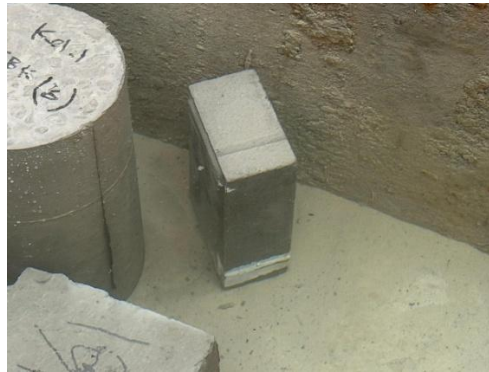
Gambar 4. 20 Uji Penyerapan Air
