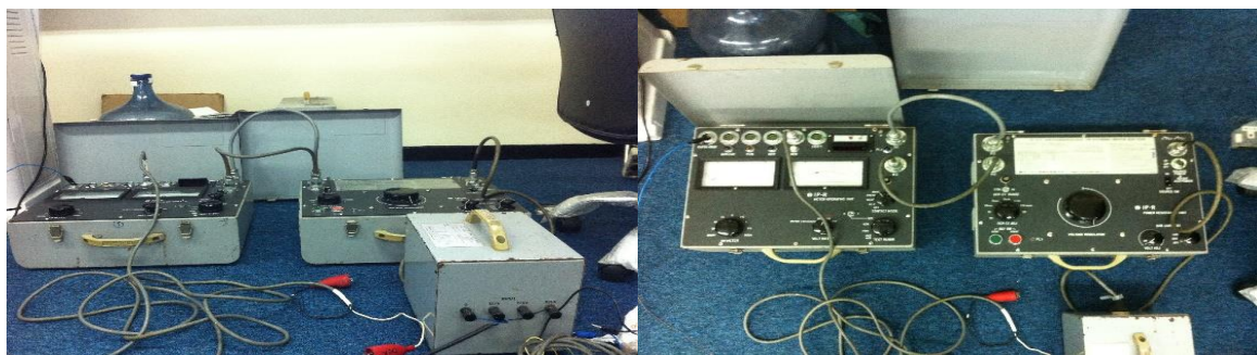
Gambar 3.5 OCR Meter yang Saling Terhubung
