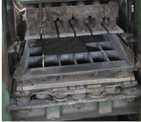
Gambar 4.2 Cetakan Paving Block
