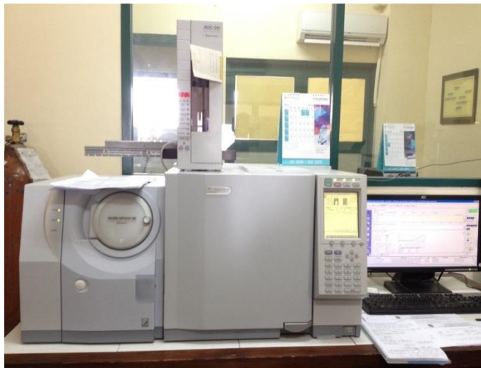
Gambar 3.5. Instrumen Gas Chromatography Mass Spectrometry (GC/MS) Shimadzu. (Sumber: Dokumentasi)
