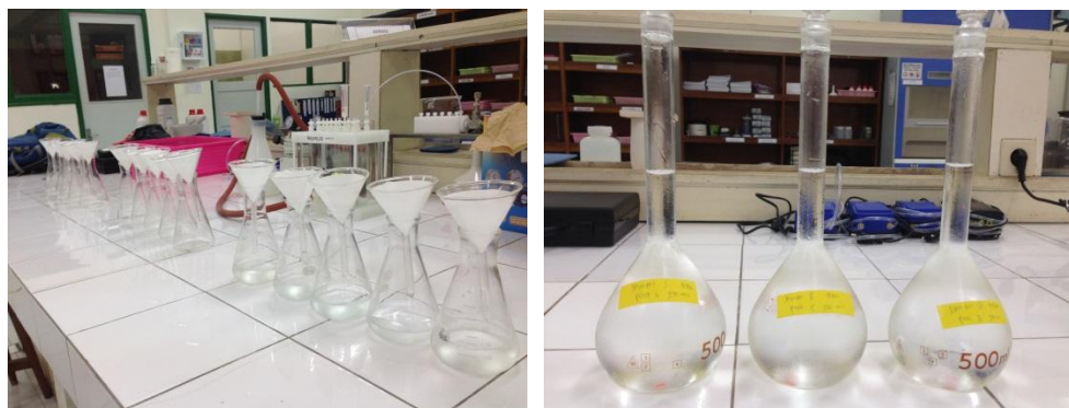
Gambar 3.3. Alat-alat Filter Sampel Air Tanah. (a) Kertas filter, corong dan erlenmeyer 250ml (b) Labu ukur 500 ml wadah sampel air tanah setelah filtering.
