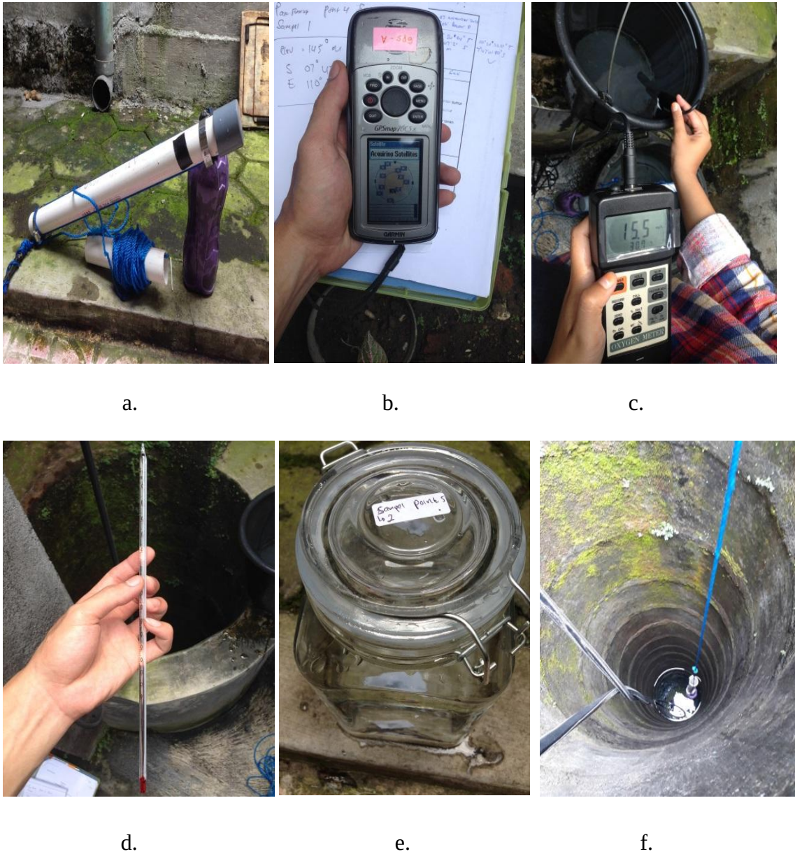
Gambar 3.2. Alat-alat Pengambilan Sampel Air Tanah. (a) Bailer Modifikasi , (b) GPS , (c) DO meter , (d) Thermometer , (e) Wadah sampe 1 liter , (f) proses pengambilan sampel air sumur .
