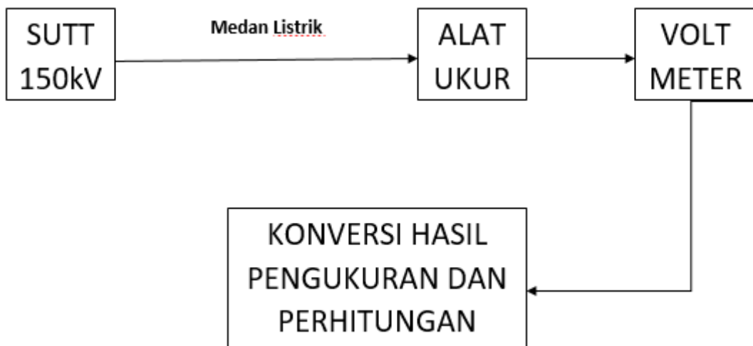
Gambar 3.1 Diagram blok alat ukur medan listrik
