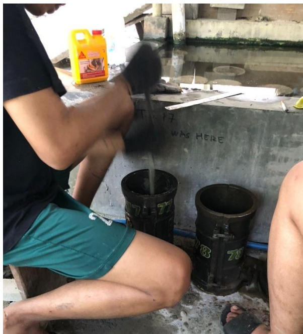
Gambar L-8. 4 Proses Pencetakan Penumbukan pada Bekisting
