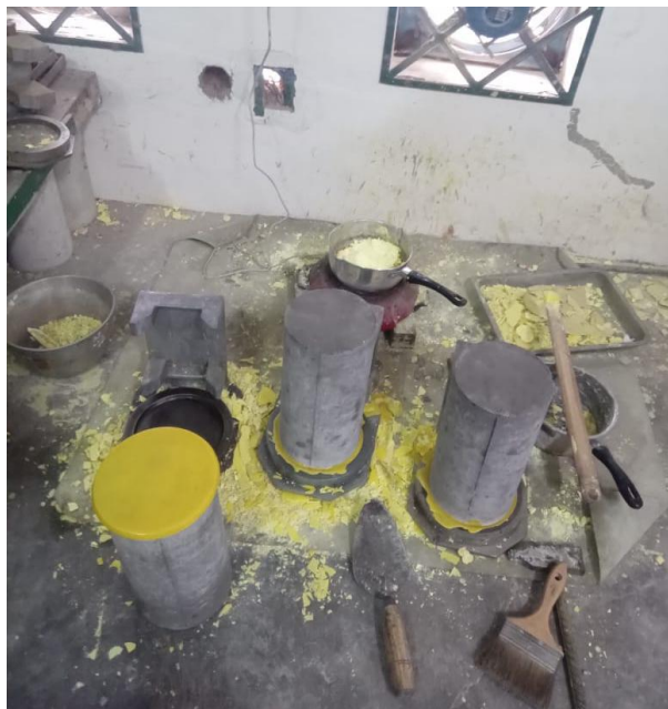
Gambar L-8. 6 Proses Persiapan Capping Sampel Beton Sebelum Pengujian
