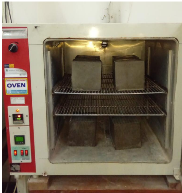
Gambar L-8. 8 Proses Pengujian Absorpsi Pengeringan Benda Uji
