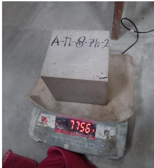
Gambar L-8. 9 Proses Pengujian Absorpsi Penimbangan Benda Uji
