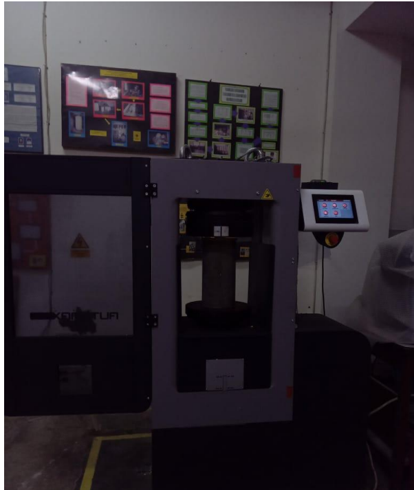
Gambar L-8. 7 Proses Pengujian Kuat Tekan Sampel Beton
