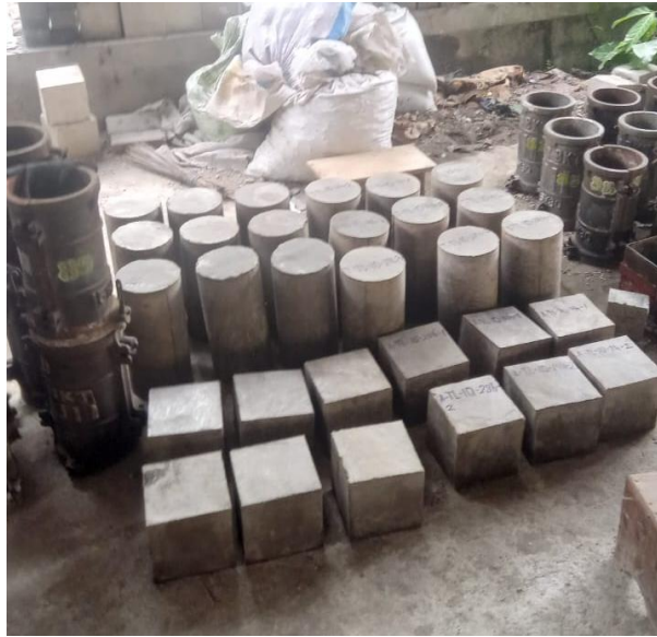
Gambar L-8. 5 Proses Perawatan Benda Uji Beton
