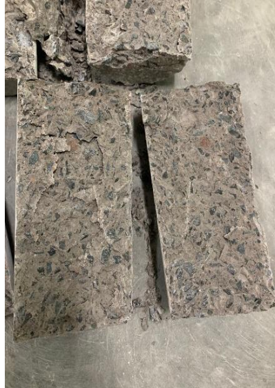
Gambar 5. 14 Kondisi Benda Uji setelah Pengujian Kuat Tarik Belah
