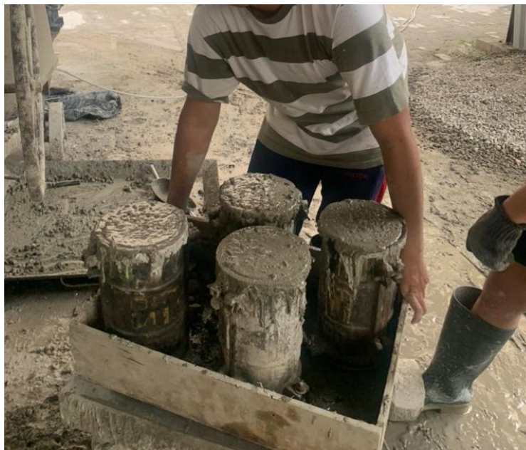
Gambar 6. 4 Proses Meratakan dengan Vibrator
