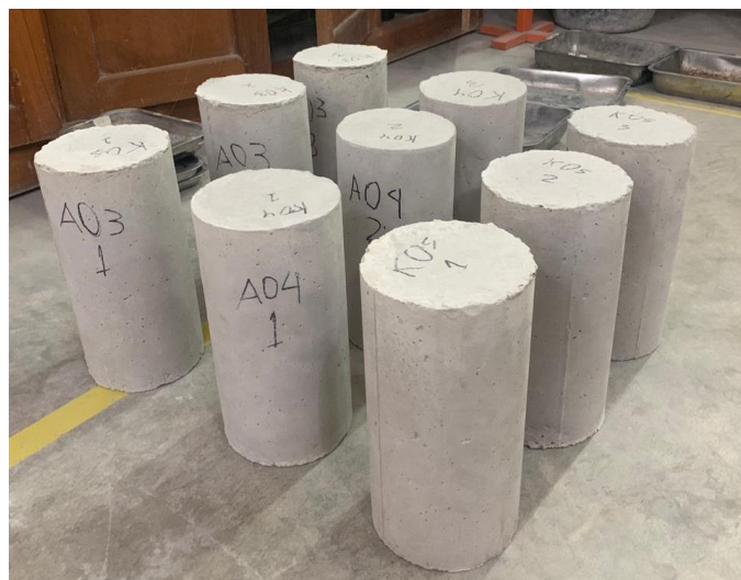
Gambar 6. 6 Beton Dilepas dari Bekisting
