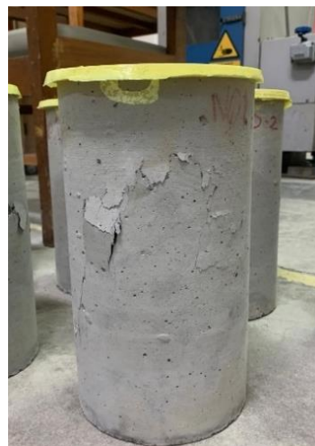
Gambar 5. 11 Kondisi Benda Uji setelah Pengujian Kuat Tekan
