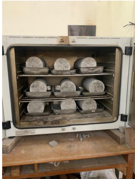
Gambar 5. 16 Pengujian Absorpsi Beton
