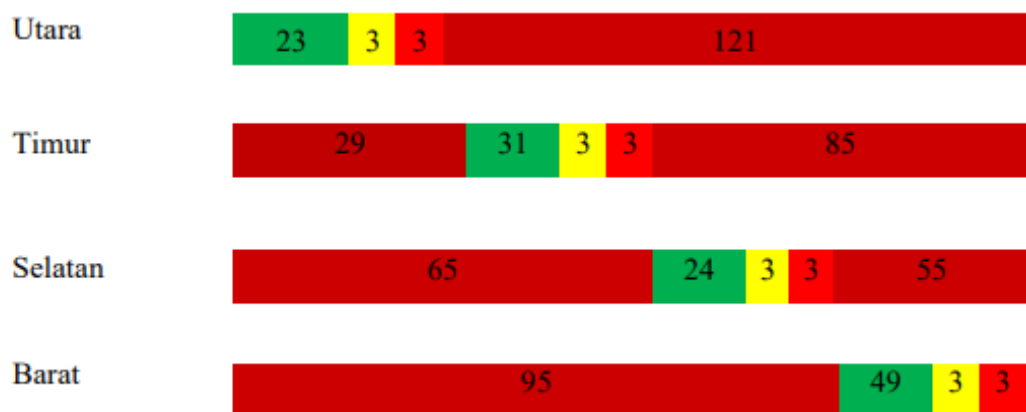
Gambar 5.17 Diagram Waktu Siklus 150 detik untuk Alternatif 1
