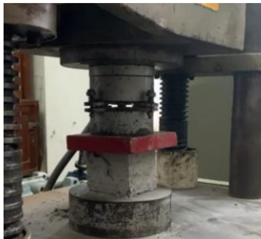
Gambar L-3. 6 Pengujian Kuat Tekan
