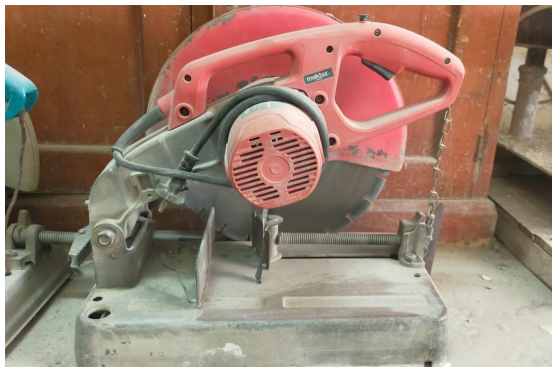
Gambar L-1. 8 Pemotong Paving block
