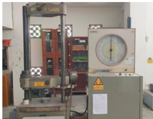
Gambar L-1. 11 Alat Uji Tekan Beton model ADR 3000
