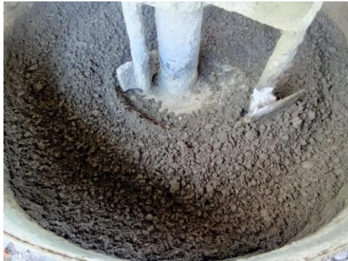
Gambar L-3. 1 Penncampuran bahan baku Paving block
