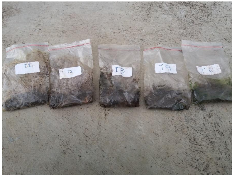
Gambar 2. Sampel tanah yang akan dikeringkan dan di ayak dengan ukuran 100 mesh sebelum nantinya diuji kandungan logam berat dengan menggunakan metode AAS Flame
