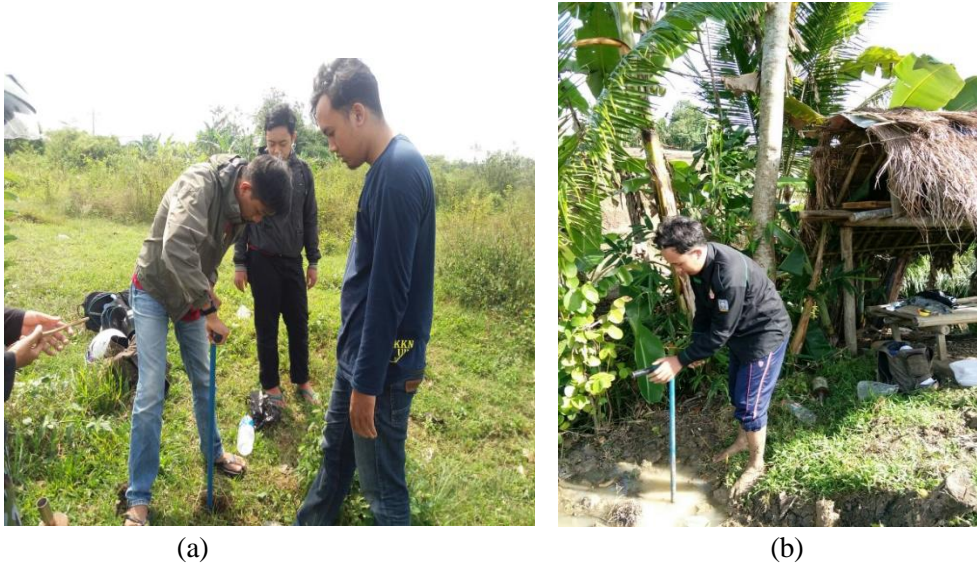
Gambar 1. Pengambilan sampel tanah di area TPA (a) dan di area persawahan (b) dilakukan dengan mencari lokasi sampel menggunakan GPS yang sudah diplot sebelumnya dengan aplikasi QGIS, pengambilan sampel ini menggunakan alat bor tangan dan langsung dimasukkan kedalam plastik serta diberi label sesuai lokasi sampel.
