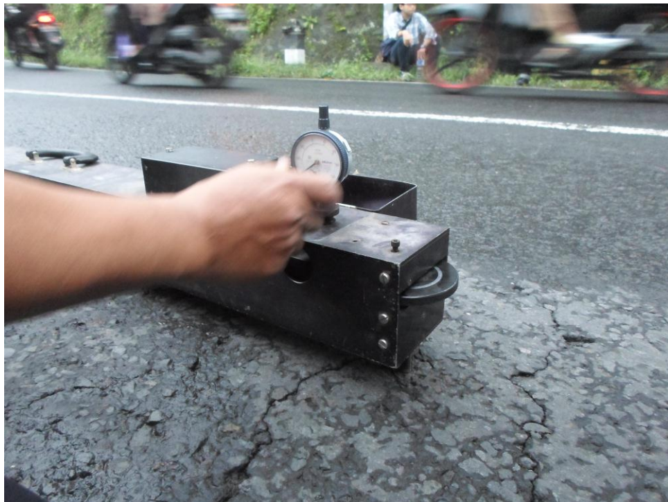
Gambar L-7.2 Uji Benkelman Beam Lajur Pakem-Turi Sta. 2+700
