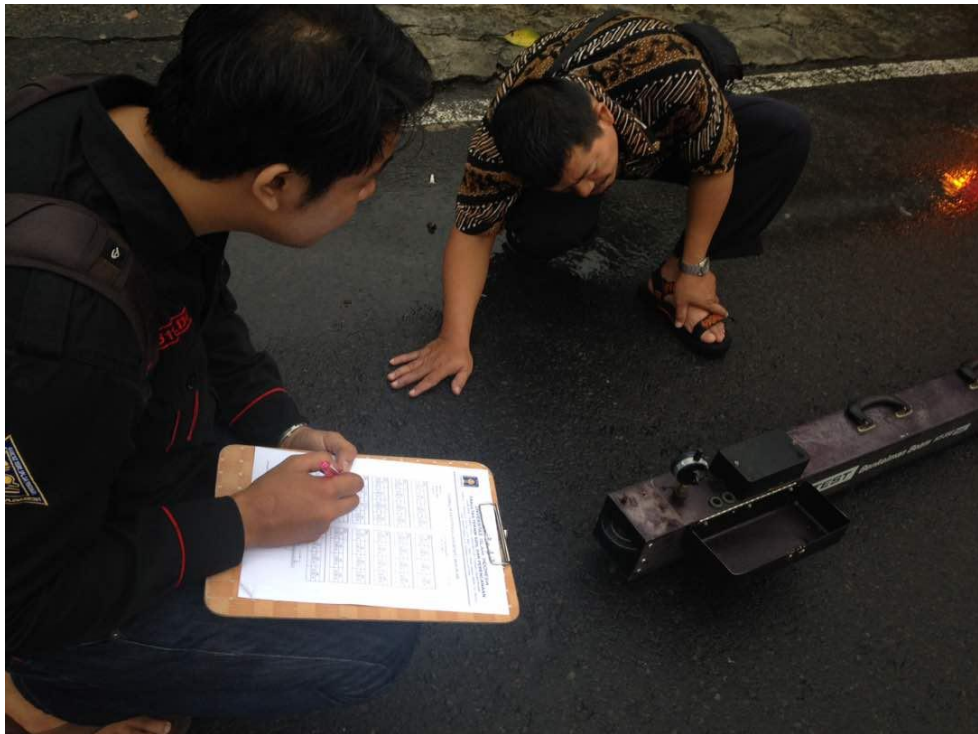
Gambar L-7.1 Uji Benkelman Beam Lajur Pakem-Turi Sta. 4+200
