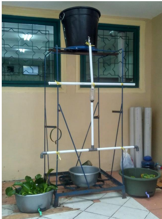
Gambar 3.4 Gambar alat pengolahan gabungan adsorpsi dan fitoremediasi
