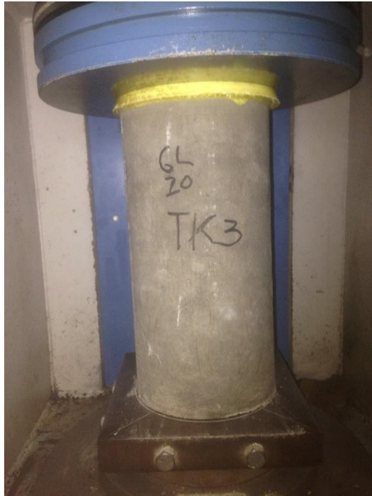
Beton saat pengujian kuat tekan
