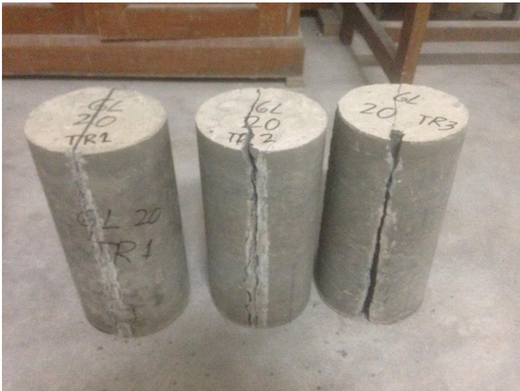
Beton setelah pengujian kuat tarik belah
