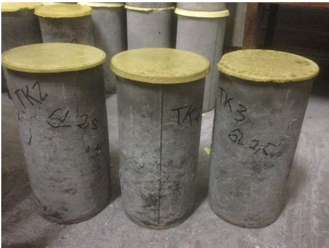
Beton setelah pengujian kuat tekan
