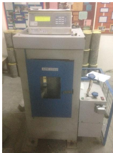
Gambar 4.16 Mesin tekan dan tarik belah beton
