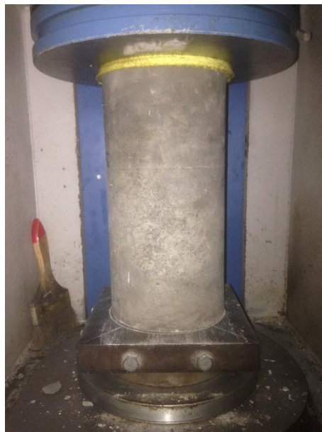
Gambar 4. 17 Perletakkan Benda Uji pada Pengujian Kuat Desak Beton
