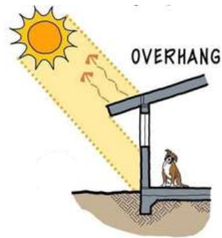
Gambar 3.24 Sistem Overhang pada Bangunan Sumber : Penulis, 2025
