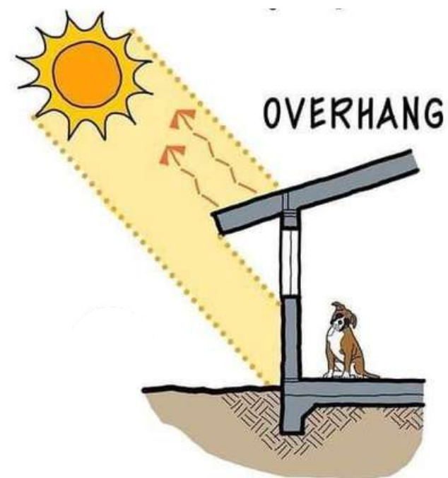
Gambar 3.18 Sistem overhang respon terhadap matahari sumber: Pinteres 2025
