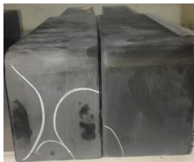
Gambar 4.4 Contoh Cacat Dekok pada Kabinet Side Base
