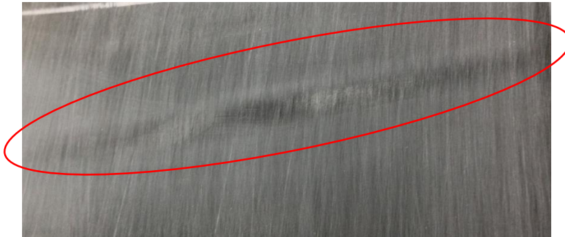
Gambar 4.5 Contoh Cacat Alur pada Kabinet Side Arm
