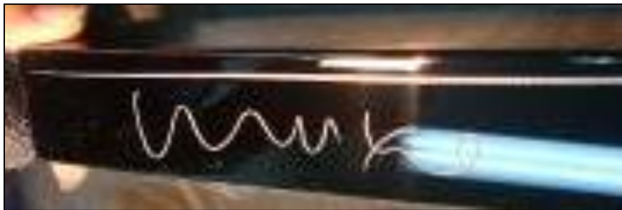
Gambar 4.3 Contoh Cacat Muke Mentori pada Kabinet Side Arm
