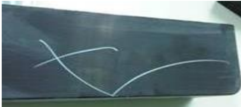
Gambar 4.2 Contoh Cacat Muke Permukaan pada Kabinet Side Base
