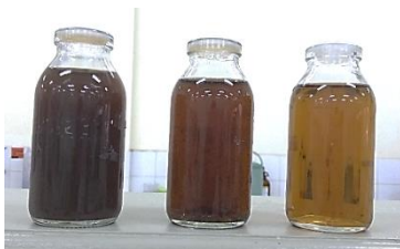
Gambar 7 Perbandingan Influen, Kontrol, dan Efluen dari Limbah dengan Penerapan Kombinasi Adsorpsi dan Fitoremediasi
