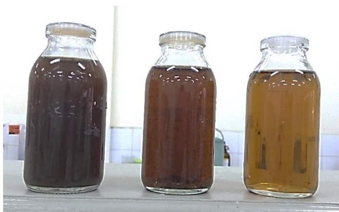
Gambar 4.16 Perbandingan Influen, Kontrol, dan Efluen dari Limbah Penyamakan Kulit dengan Penerapan Kombinasi Adsorpsi dan Fitoremediasi
