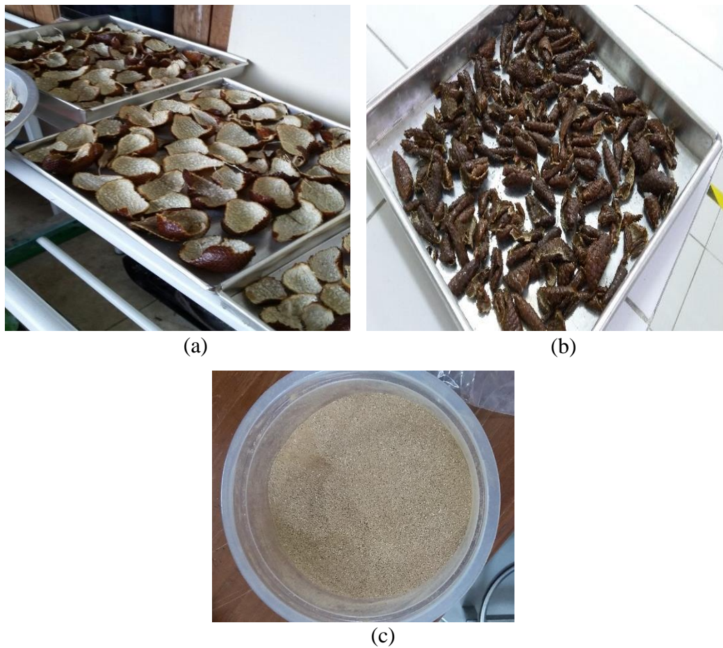
Gambar 3.2 (a) Kulit salak sebelum dioven, (b) Kulit salak sesudah dioven, (c) Serbuk kulit salak setelah dihaluskan dan diayak ukuran 50 mesh
