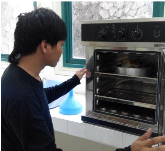
Proses pengukuran berat kering sampel daun untuk bahan bakar briket
