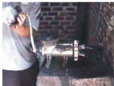
Pencetakan briket menggunakan ekstruder kapasitas ½ kg
