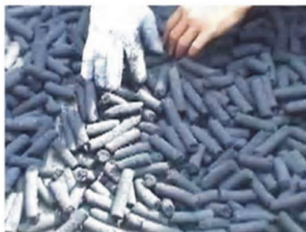
Bentuk briket arang sekam padi yang dikeringkan terik matahari selama 8 jam
