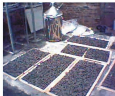
Bentuk briket arang sekam padi yang dikeringkan terik matahari selama 8 jam
