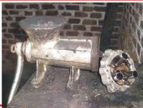
Pencetakan briket menggunakan ekstruder kapasitas ½ kg
